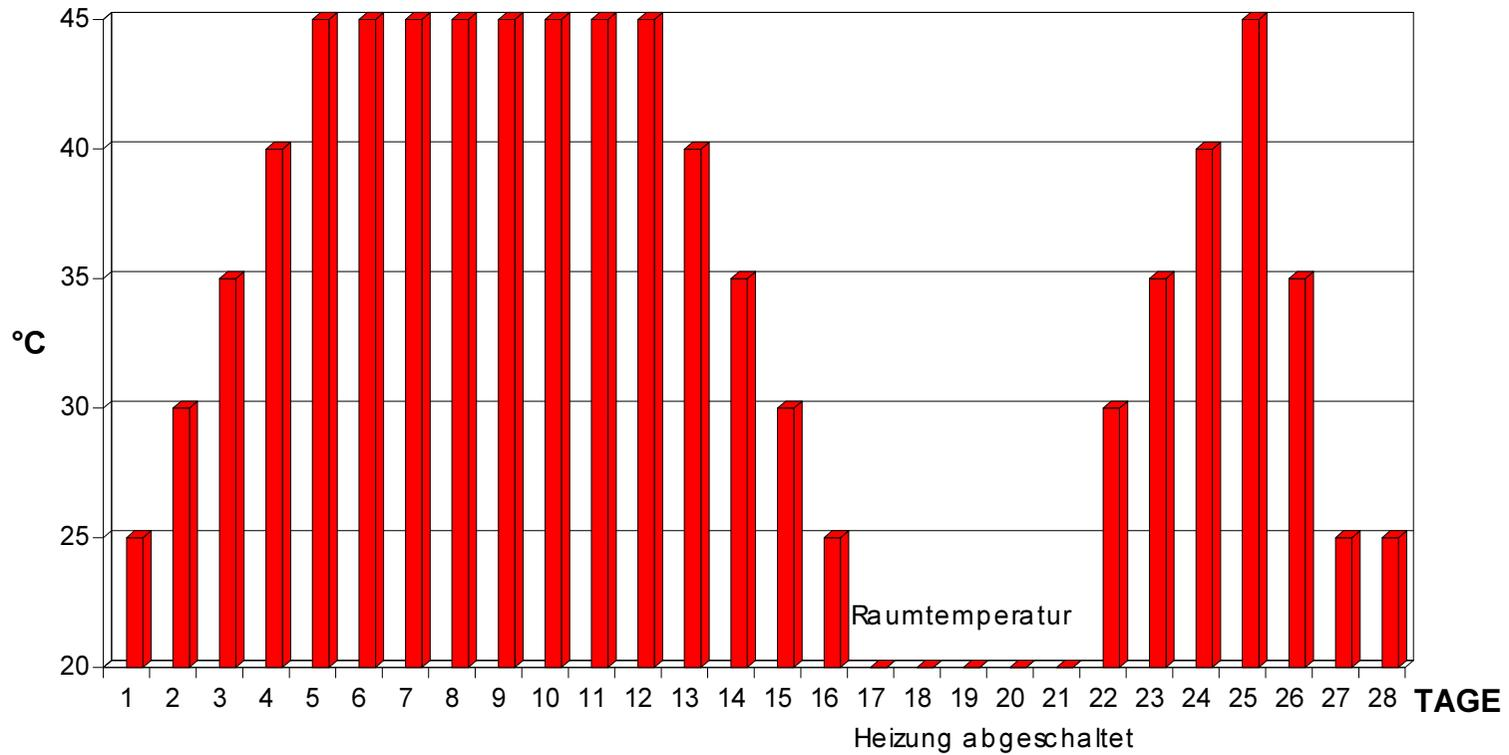
Der Zeitraum, in dem die Heizung zum ersten Mal auf Voll-Last gefahren werden muss, ist abhängig von der Estrichart und Estrichstärke:
